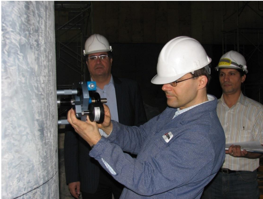
اجرای تست Pull off توسط کارشناس بخش سازه موسسه EMPA در هتل بزرگ آزادی تهران
