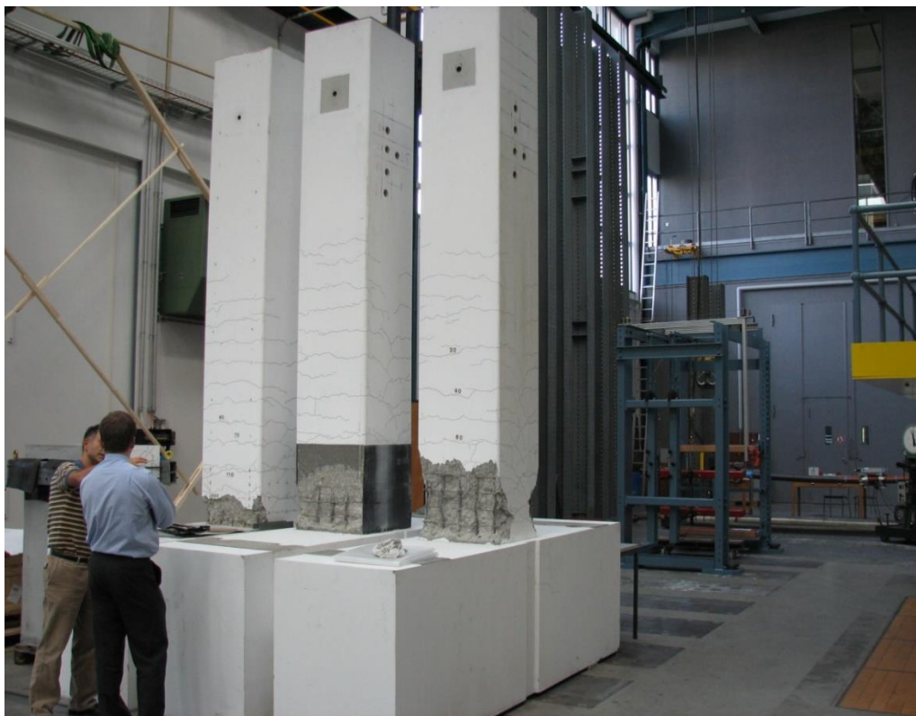
سه عدد از نمونه ستون‌های هتل آزادی پس از تست بارگذاری جانبی -بخش سازه موسسه EMPA سوئیس
